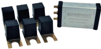
Система предназначена для бесконтактного измерения температуры элементов систем электропередач и распределительного оборудования (коммутаторов). Датчики полностью пассивны и не требуют питания. Возможно одновременное считывание информации с 6 датчиков, при необходимости число датчиков может быть увеличено. Датчики идентифицируемы. Считывающее устройство должно быть подключено к компьютеру (не входит в комплект поставки), в котором происходит накопление данных по температуре.
