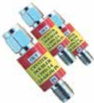
Удвоители частоты компании **Crystek** помещены в надежный металлический корпус с SMA соединителями. Они предназначены для работы в диапазоне входных частот 850 МГц ...4 ГГц, при максимальном уровне возбуждения 10...20 дБм. Типовые потери преобразования и уровень развязки составляют 13 дБ и 33 дБ соответственно. Такие удвоители частоты идеальны для лабораторных применений и при тестировании оборудования. Рабочий температурный диапазон -40...+85 °С.
