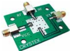
Компания Crystek предлагает отладочные платы для тестирования ГУНов в диапазоне частот 0...6 ГГц. Материалом основания такой платы является FR-4 толщиной 0,062" (0,157 см). Рабочий температурный диапазон составляет -40...+85 °С. ГУН присоединяется к площадке методом пайки, что позволяет обеспечить необходимое заземление в процессе тестирования. Отладочные платы предназначены для ГУНов с корпусами 0,3 x 0,3 или 0,5 x 0,5 дюймов.
