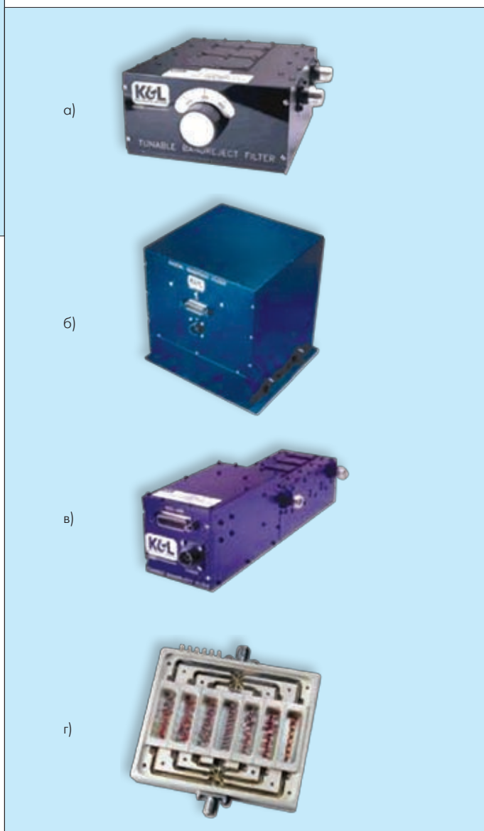
Рис.9. Блоки управляемых фильтров: а) серия TNF (ПЗФ с ручным управлением: f_0 = 30-2000 МГц, n = 3-5 , BW_{3дБ} = 1-3 МГц, k_{40дБ/3дБ} = 16-100 , IL = 0,5 дБ, I_{iso} > 50 дБ, P_{вх} = 50 Вт); б) перестраиваемый ППФ на диэлектрических волноводах ( f_0 = 850-970 МГц и 1700–2000 МГц, BW_{3дБ} = 0,1\% , I_{iso} > 60 дБ; BW_{3дБ}/f_0 = 20\% ); в) серия D3TNF (ПЗФ с цифровым управлением: f_0 = 800-2200 МГц, n = 3-5 , BW_{3дБ} = 1,6-11 МГц; IL = 0,5 дБ; I_{iso} > 50 дБ; P_{вх} = 50 Вт); г) коммутируемый банк фильтров
