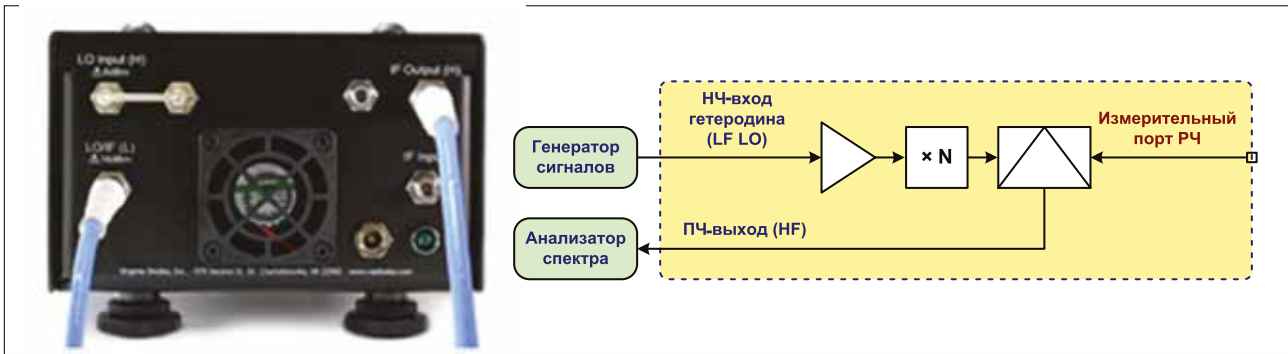
▲ Рис. 39. Преобразование сигнала вниз по частоте с использованием низкочастотного входного порта гетеродина. Входной ПЧ-порт не используется
