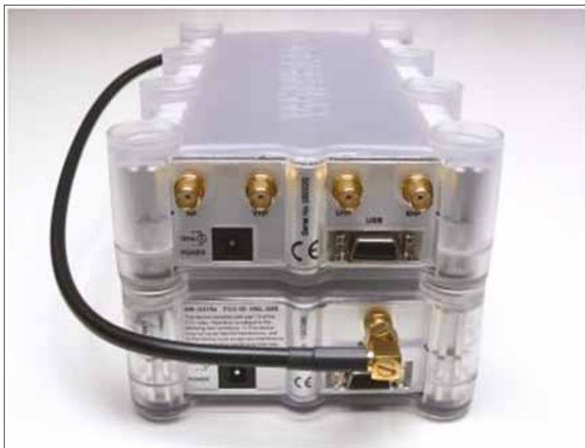
▲ Рис. 55. Расширитель WiNRADiO AMFE устанавливается поверх приемника WR-G315e
