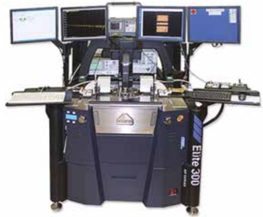
▲ Рис. 64. Модуль измерения шумовых характеристик MT7553B в типовой системе на пластине (on-wafer setup) с измерением параметров шума на частотах 10 МГц...50 ГГц
