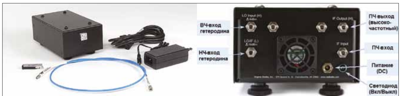
▲ Рис. 37. Комплект модуля расширения рабочего диапазона анализатора спектра серии SAX компании Virginia Diodes (VDI) и вид на заднюю панель
