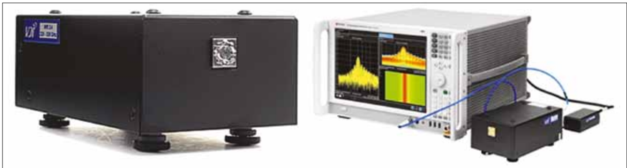
▲ Рис. 42. Модель расширителя частот N9029AV03 перекрывает диапазон WR3.4 220–330 ГГц
