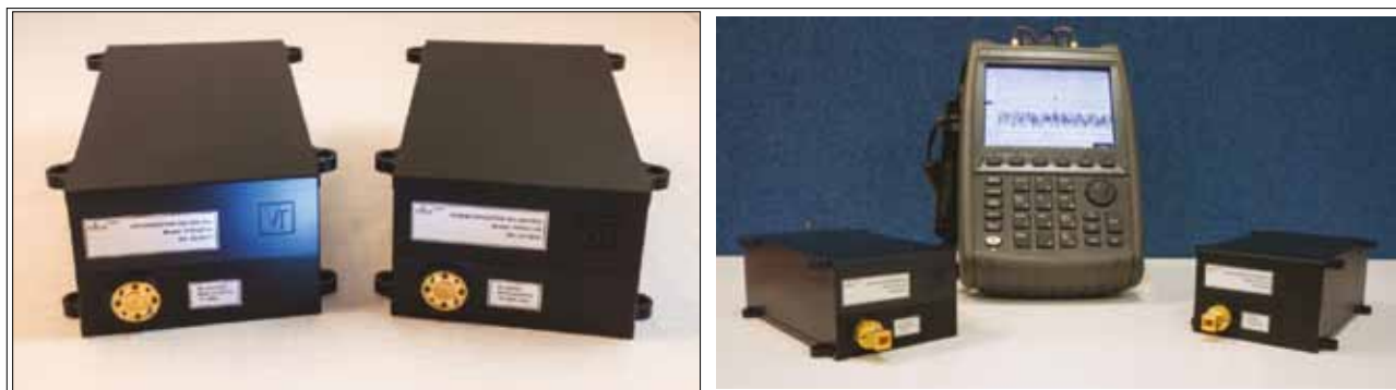
▲ Рис. 46. 300-ГГц расширители частот компании VivaTech для портативных ПЧ-анализаторов от Keysight (Agilent) FieldFox
