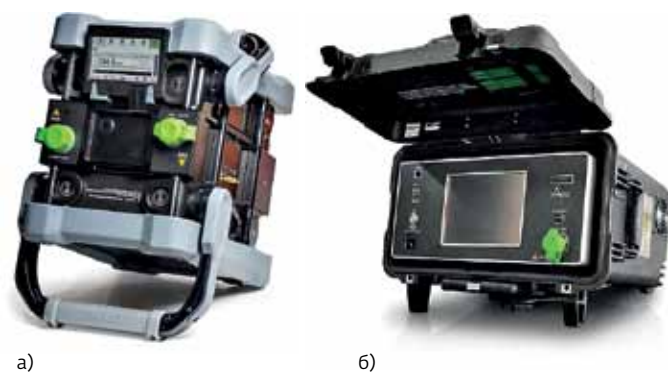
Рис.6. Измерители уровня ПИМ компании Kaelus: а) батарейный тестер серии iTA, б) носимый анализатор серии iQA
