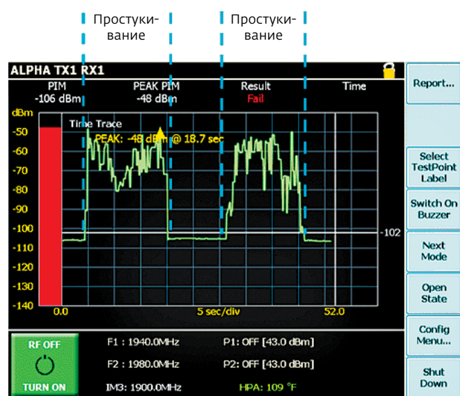
Рис.5. Динамический ПИМ-тест при простукивании компонентов в присутствии тестового сигнала
