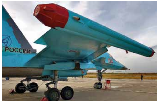
Рис.9. Военный самолет с контейнером для РЭБ на консоли крыла
